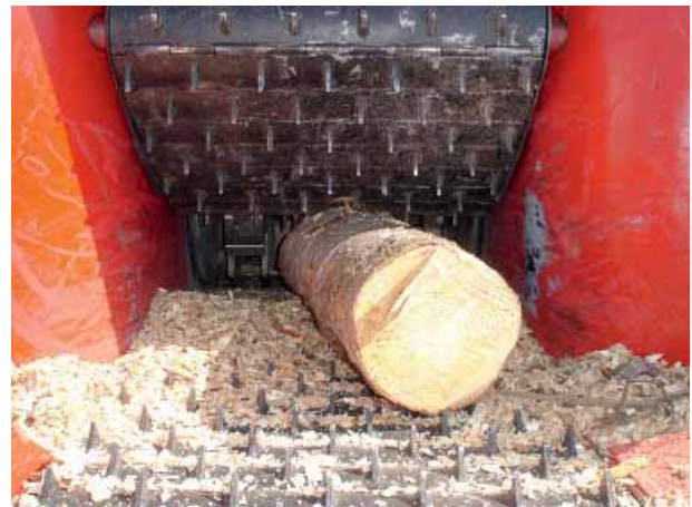
Anbauhacker mit Kranbeschildung (Detail Einzug und Trommel)
