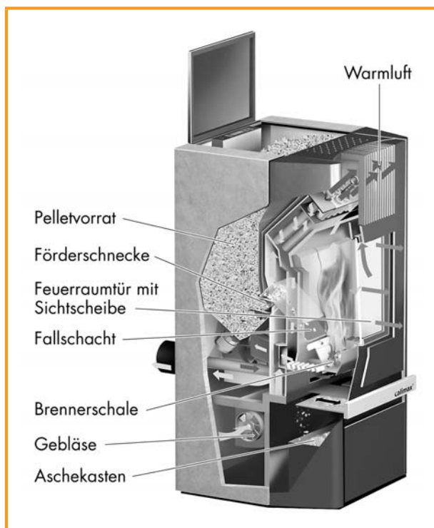
Abb. 2-1: Beispiel eines Pelletofens (Warmluftgerät) (Grafik: calimax)
